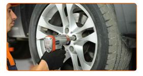
Rimettere il veicolo per terra e, lavorando in ordine incrociato, serrare i bulloni di fissaggio delle ruote. Usa la chiave a bussola per dadi cerchio ruota n.17. Usa una chiave dinamometrica. Serralo fino allo coppia di torsione di 130 Nm.
