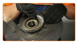
Estrarre il cuscinetto del mozzo della ruota. Usare un set di montaggio/smontaggio cuscinetti e boccole.
