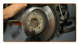
Serrare l'attacco del disco freno. Usa una chiave HEX N.H6. Usa una chiave dinamometrica. Serralo fino allo coppia di torsione di 9 Nm.
