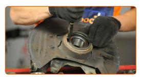
Premere il mozzo della ruota nella gabbia interna del cuscinetto. Usare un set di montaggio/smontaggio cuscinetti e boccole.
