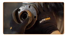
Tratta la sede di montaggio del puntone dell'ammortizzatore sul fuso a snodo. Usa una spazzola metallica. Usa lo spray WD-40.
