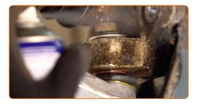
Svita l'elemento di fissaggio che collega il giunto sferico del braccio di controllo anteriore al fuso a snodo. Utilizza una chiave a bussola N°22. Usa una chiave a cricchetto.
