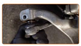
Serra il bullone di fissaggio che collega la testina tirante al fuso a snodo. Utilizza una chiave a bussola N°22. Usa una chiave dinamometrica. Serralo fino allo coppia di torsione di 80 Nm.
