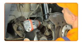
Installa l'albero di trasmissione all'interno del mozzo della ruota.
