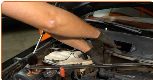
**12** Rimuovere la copertura del motore.
