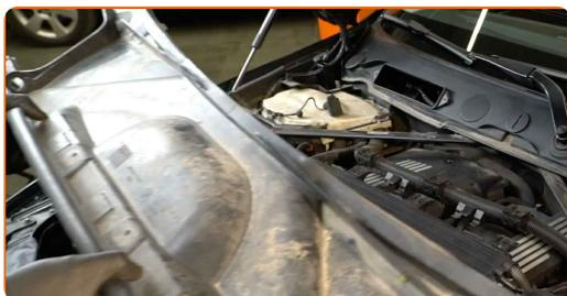
**11** Svita gli elementi di fissaggio del coperchio del motore. Usa una chiave HEX N.H5. Usa una chiave a cricchetto.
