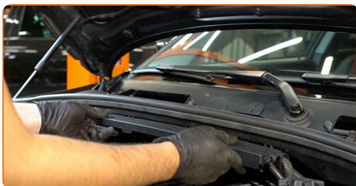
**27** Reinstallare il coperchio della scatola filtro abitacolo. Assicurati di sentire un clic indicante che si trova installato saldamente.
