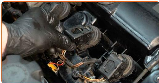
**14** Tratta il connettore delle bobine di accensione con uno spray per dispositivi elettronici. Lo spray proteggerà i contatti elettrici dalla corrosione, l'ossidazione e la resistenza di contatto.
