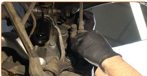
**23** Installare la molla di fissaggio della pinza freno.
