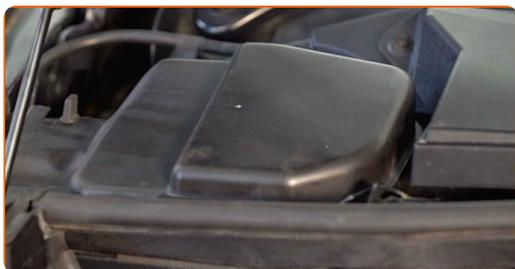
**43** Rimuovi la copertura di protezione del parafrango.
