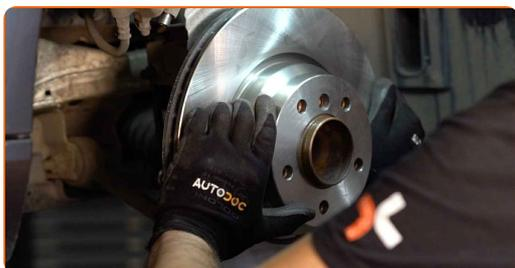
**24** Serrare l'attacco del disco freno. Usa una chiave HEX N.H5. Usa una chiave dinamometrica. Serralo fino allo coppia di torsione di 16 Nm.
