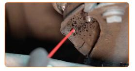
Svita gli elementi di fissaggio inferiori del supporto del motore. Utilizza una chiave a bussola N°16.
