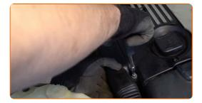
Serra gli elementi di fissaggio inferiori del supporto del motore. Utilizza una chiave a bussola N°16. Usa una chiave dinamometrica. Serralo fino allo coppia di torsione di 65 Nm.
