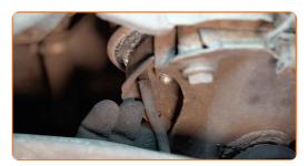
Tratta con del prodotto gli elementi di fissaggio del supporto motore. Usa lo spray WD-40.
