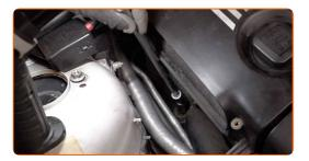
Sostieni il motore a livello della coppa dell'olio. Usa un cric idraulico per trasmissione.
