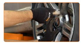
Rimettere il veicolo per terra e, lavorando in ordine incrociato, serrare i bulloni di fissaggio delle ruote. Usa una chiave dinamometrica. Serralo fino allo coppia di torsione di 120 Nm.
