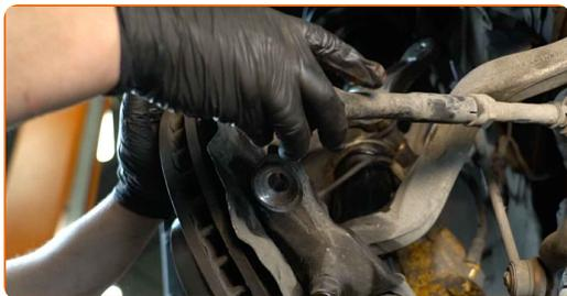
**11** Pulire gli elementi di fissaggio del sensore livellamento fari. Usa una spazzola metallica. Usa lo spray WD-40.
