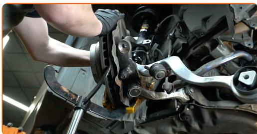
**32** Tratta la sede di montaggio del puntone dell'ammortizzatore sul fuso a snodo. Usa una spazzola metallica. Usa lo spray WD-40.
