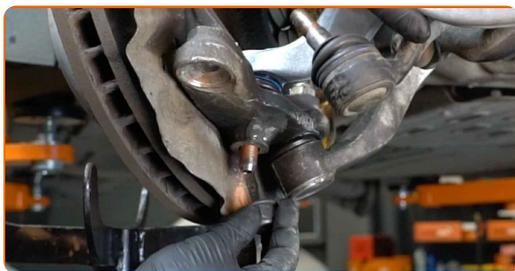
**31** Solleva il cric idraulico per trasmissione di 10-15 cm.
