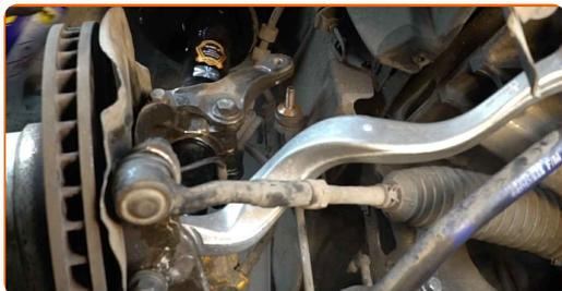
**45** Serra gli elementi di fissaggio del tirante della barra stabilizzatrice. Utilizza una chiave combinata N°16.
