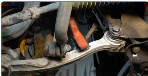
**12** Svitare gli elementi di fissaggio del sensore livellamento fari. Utilizza una chiave combinata N°9. Utilizza una chiave combinata N°10.
