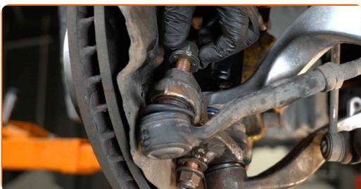
**41** Avvita il dado di serraggio che collega le testine tiranti dello sterzo al fuso a snodo. Utilizza una chiave a bussola N°21. Usa una chiave a cricchetto.
