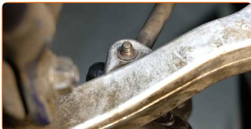
**47** Avvitare gli elementi di fissaggio del sensore livellamento fari. Utilizza una chiave combinata N°9. Utilizza una chiave combinata N°10.
