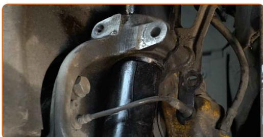
**33** Avvitare l'elemento di fissaggio della staffa supporto del puntone stabilizzatore. Utilizza una chiave a bussola N°16. Usa una chiave a cricchetto.
