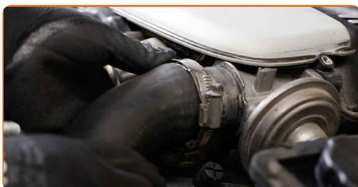
**48** Avvitare la fascetta del tubo dell'intercooler (interrefrigeratore). Utilizza una chiave a bussola N°7. Usa una chiave a cricchetto.
