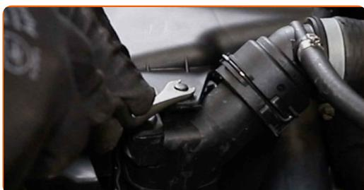
**5** Svitare l'elemento di fissaggio della ventola di raffreddamento. Utilizza una chiave combinata N°32 (2 pezzi).
