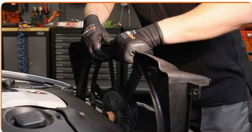
**7** Svita gli elementi di fissaggio del coperchio del motore. Usa una chiave HEX N.H5. Usa una chiave a cricchetto.
