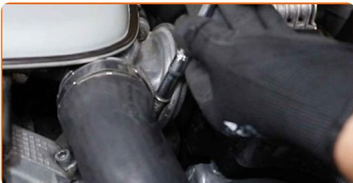
**14** Rimuovere il tubo dell'intercooler (interrefrigeratore).
