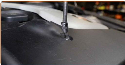
66 Rimuovi la copertura di protezione del parafrango.
