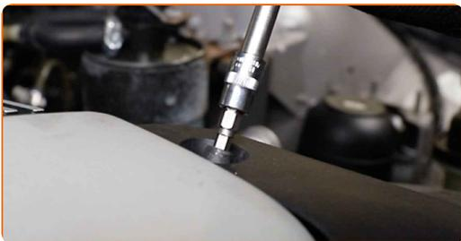
**8** Rimuovere la copertura del motore.
