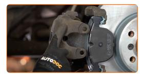
Montare i tappi dei parapolvere delle guide pinza freno.
