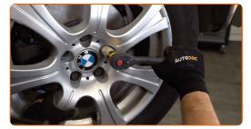
Rimettere il veicolo per terra e, lavorando in ordine incrociato, serrare i bulloni di fissaggio delle ruote. Usa una chiave dinamometrica. Serralo fino allo coppia di torsione di 140 Nm.
