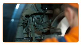
Serra l'elemento di fissaggio che collega il braccio di sospensione allo snodo posteriore. Utilizza una chiave combinata N°22. Usa la chiave Torx T 40. Usa una chiave dinamometrica. Serralo fino allo coppia di torsione di 165 Nm.
