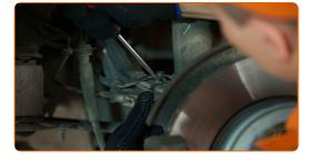
Rimuovere la staffa di fissaggio del cablaggio sensore ABS dal braccio superiore. Usa un giravite piatto.
