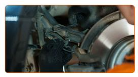
Collegare il cablaggio del sensore ABS.
