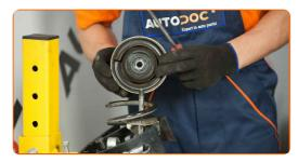
Serrare la vite dell'asta pistone supporto ammortizzazione. Utilizza una chiave combinata N°18. Usa una chiave HEX N.H7. Usa una chiave dinamometrica. Serralo fino allo coppia di torsione di 27 Nm.
