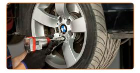
Rimettere il veicolo per terra e, lavorando in ordine incrociato, serrare i bulloni di fissaggio delle ruote. Usa la chiave a bussola per dadi cerchio ruota n.17. Usa una chiave dinamometrica. Serralo fino allo coppia di torsione di 120 Nm.
