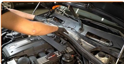
**22** Avvitare gli elementi di fissaggio della parte inferiore del deflettore acqua. Utilizza una chiave a bussola N°8. Usa una chiave a cricchetto.
