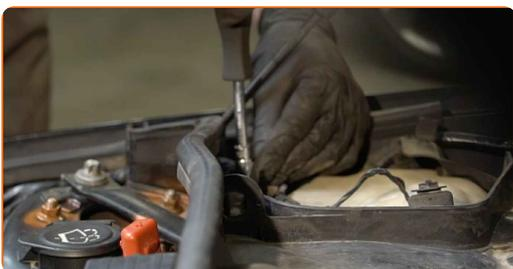
**9** Scollega la canalina del cavo dalla parte superiore della scatola del microfiltro dell'aria. Usa un giravite piatto.
