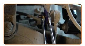
Svita l'elemento di fissaggio che collega la barra stabilizzatrice al braccio di sospensione. Utilizza una chiave combinata N°18. Usa una chiave HEX N.H6. Usa una chiave a cricchetto.
