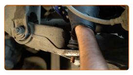
Serra gli elementi di fissaggio del tirante della barra stabilizzatrice. Utilizza una chiave combinata N°15. Utilizza una chiave combinata N°18. Usa una chiave HEX N.H6. Usa una chiave a cricchetto.
