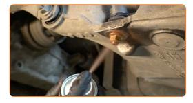
Pulisci la sede di montaggio dei cerchioni della ruota. Usa una spazzola metallica. Tratta la superfice nella quale il disco freno fa contatto con il cerchione della ruota. Usa il grasso al rame.
