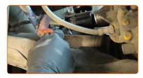
Installa il puntone stabilizzatore trasversale.
