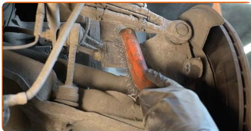
**21** Svita l'elemento di fissaggio inferiore del supporto di ammortizzazione. Utilizza una chiave combinata N°18.
