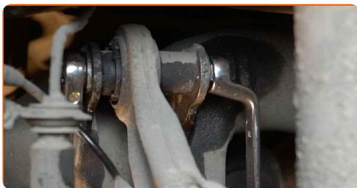
**20** Pulisci gli elementi di fissaggio del puntone dell'ammortizzatore. Usa una spazzola metallica. Usa lo spray WD-40.
