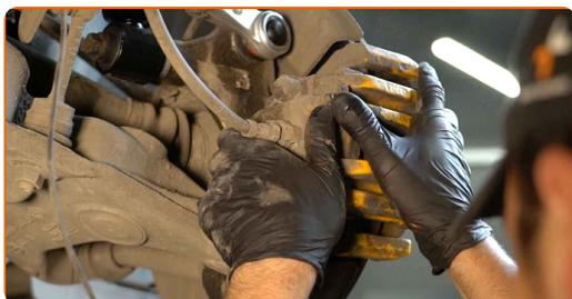
**63** Serrare il sostegno pinza freno. Utilizza una chiave a bussola N°18. Usa una chiave dinamometrica. Serralo fino allo coppia di torsione di 110 Nm.
