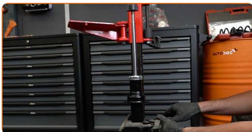
**40** Installare il parapolvere e il limitatore flessione dinamica sul nuovo ammortizzatore.
