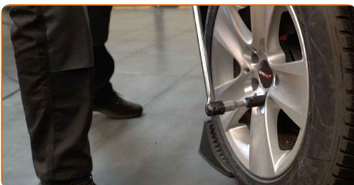
**11** Sollevare la parte posteriore del veicolo e fissarlo per mezzo di appoggi.
