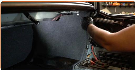
**75** Installa le clip di plastica della parte anteriore del rivestimento laterale del cofano.
