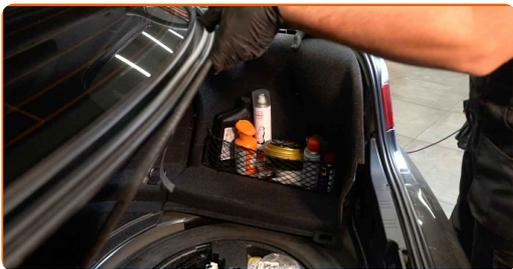
**5** Rimuovi il clip di plastica della parte anteriore del rivestimento laterale del cofano. Usa uno strumento per estrazione clip.
