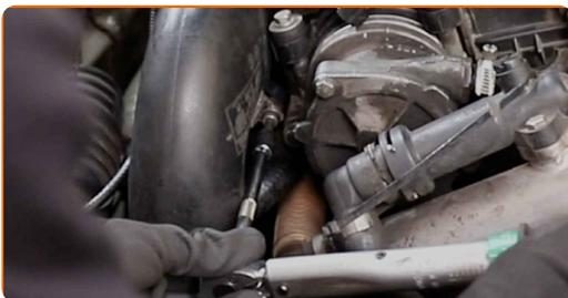
27 Applicare un prodotto trattante sul connettore del sensore del flusso d'aria di massa. Usa il grasso al silicone.
