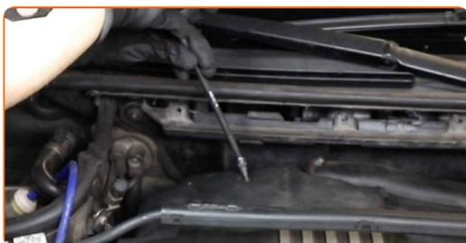
**33** Reinstallare l'alloggiamento del gruppo di distribuzione dell'aria.
