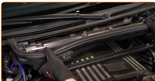
**12** Svita gli elementi di fissaggio del coperchio del motore. Usa una chiave HEX N.H5. Usa una chiave a cricchetto.
