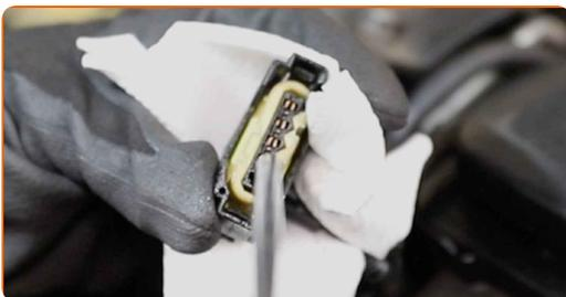
28 Collegare il connettore del sensore del flusso d'aria di massa.
