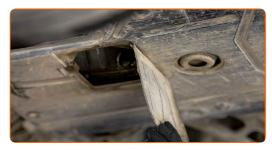
Serra gli elementi di fissaggio del coperchio inferiore della coppa dell'olio. Usa un cacciavite Phillips.
