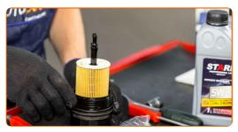
Avvitare il nuovo filtro nella posizione di lavoro. Usa la bussola 86/16 F. Usa una chiave dinamometrica. Serralo fino allo coppia di torsione di 23 Nm.
