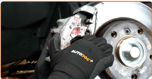
**29** Serrare il sostegno pinza freno. Utilizza una chiave a bussola N°16. Usa una chiave dinamometrica. Serralo fino allo coppia di torsione di 110 Nm.
