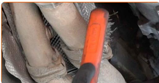
25 Svitare gli elementi di fissaggio dell'impianto di scarico. Utilizza una chiave combinata N°13. Utilizza una chiave a bussola N°13. Usa una chiave a cricchetto.
