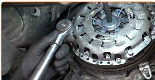
**54** Svitare la piastra di bloccaggio dello spingidisco. Usa una chiave HEX N.H14. Usa una chiave a cricchetto.
