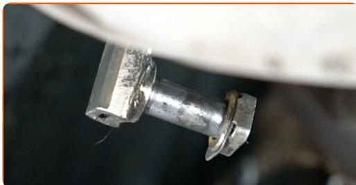
24 Pulire l'elemento di fissaggio del sistema di scarico. Usa una spazzola metallica. Usa lo spray WD-40.
