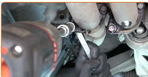
26 Rimuovi gli elementi di fissaggio del sistema di scarico.
