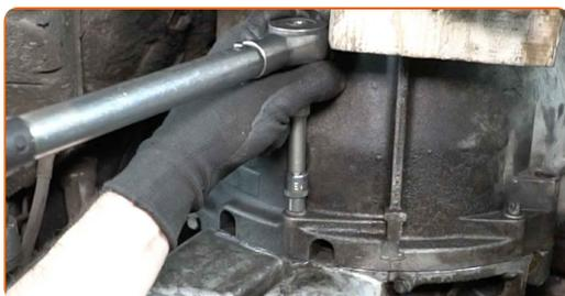
**72** Fissare il braccio di supporto della leva del cambio.
