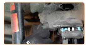
21 Installare la molla di fissaggio della pinza freno.
