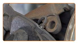
Montare la pinza del freno e fissarla. Usa una chiave HEX N.H7. Usa una chiave dinamometrica. Serralo fino allo coppia di torsione di 30 Nm.
