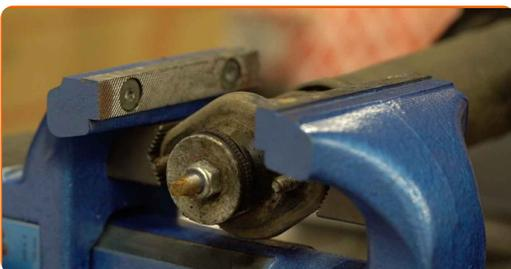
17 Pulisci l'elemento di fissaggio dell'asta dell'ammortizzatore. Usa una spazzola metallica.
