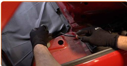
**3** Pulisci gli elementi di fissaggio del supporto superiore dell'ammortizzatore. Usa lo spray WD-40.
