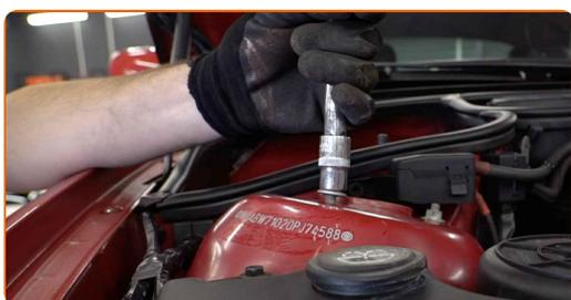
**18** Svita gli elementi di fissaggio superiori del puntone dell'ammortizzatore.
