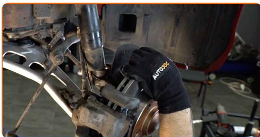
**17** Svitare l'elemento di fissaggio del supporto di ammortizzazione. Utilizza una chiave a bussola N°13. Usa una chiave a cricchetto.
