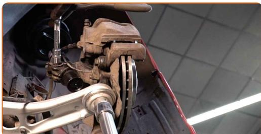
**47** Fissare sul montante il tubo dell'impianto freni. Collega gli elementi di fissaggio del cavo sensore ABS ai supporti di ammortizzazione.
