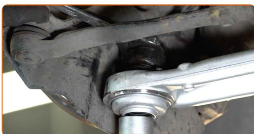
**46** Serra gli elementi di fissaggio inferiori che collegano l'ammortizzatore al fuso a snodo. Utilizza una chiave a bussola N°21. Usa una chiave dinamometrica. Serralo fino allo coppia di torsione di 80 Nm.
