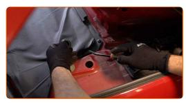
Pulisci gli elementi di fissaggio del supporto superiore dell'ammortizzatore. Usa lo spray WD-40.
