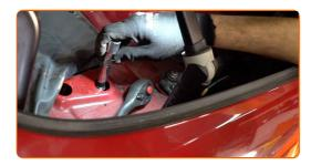
Stringi l'elemento di fissaggio inferiore dell'ammortizzatore. Utilizza una chiave a bussola N°18. Usa una chiave dinamometrica. Serralo fino allo coppia di torsione di 100 Nm.
