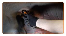
Collocare l'ammortizzatore nell'arco passaruota e fissalo.
