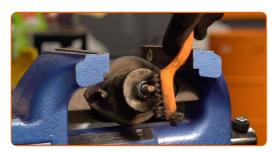
Rimuovere l'elemento di fissaggio dell'asta pistone ammortizzatore. Utilizza una chiave combinata N°17.
