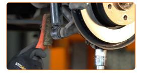
Avvita l'elemento di fissaggio inferiore dell'ammortizzatore. Utilizza una chiave a bussola N°18. Usa un giramaschi.
