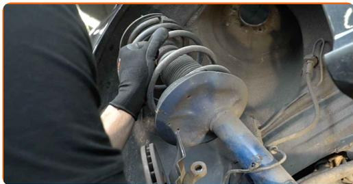
**19** Montare il supporto di ammortizzazione sul dispositivo speciale per la compressione delle molle.
