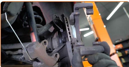
**17** Pulisci la superficie del disco freno. Usa una spazzola metallica. Usa lo spray WD-40.
