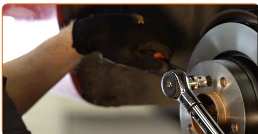
**24** Pulire il sostegno pinza freno da sporco e polvere. Usa una spazzola metallica. Usa un pulitore freni.
