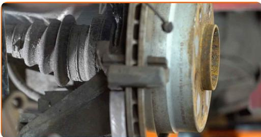
**15** Svitare l'attacco della staffa pinza freno. Utilizza una chiave a bussola N°16. Usa una chiave a cricchetto. Usa un giramaschi.
