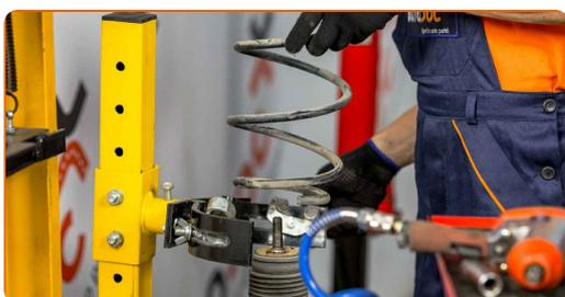
**35** Rimuovi il parapolvere e il paracolpi dell'ammortizzatore.
