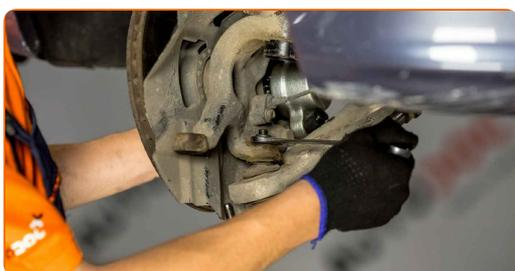
55 Puntellare il braccio. Usa un cric idraulico per trasmissione.
