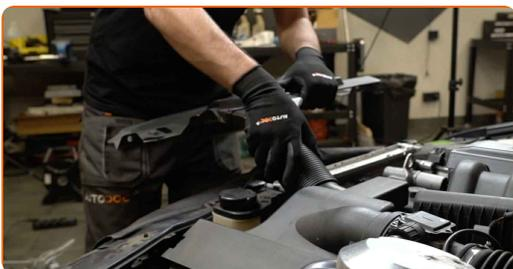
**5** Svitare il tappo del serbatoio del liquido di raffreddamento.
