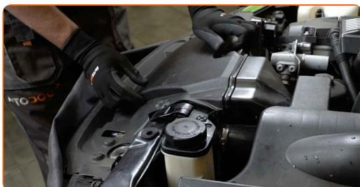
**41** Installa gli elementi di fissaggio dell'alloggiamento del condotto dell'aria.
