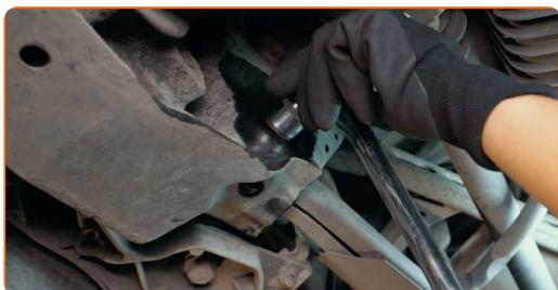
**12** Sorreggere il fuso a snodo posteriore. Usa un cric idraulico per trasmissione.
