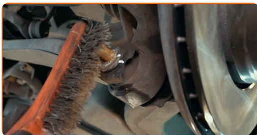
**10** Rimuovi i bulloni di fissaggio. Utilizza una chiave a bussola N°18. Usa un piede di porco.
