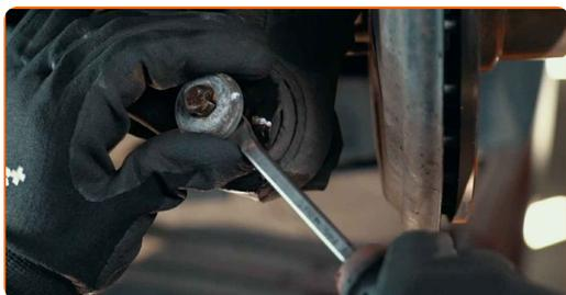
**11** Svitare l'elemento che fissa il braccio al telaio di base. Utilizza una chiave a bussola N°18. Usa un piede di porco.
