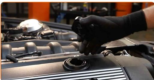
**8** Rimuovere la copertura del motore.
