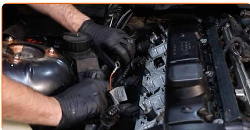
**31** Serra i terminali della carrozzeria (terra) delle bobine di accensione. Utilizza una chiave a bussola N°8. Usa una chiave a cricchetto.
