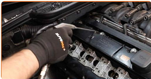
**17** Rimuovi il tubo di ventilazione del carter motore.
