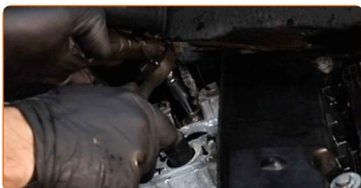
**29** Installa il tubo flessibile del sistema di ventilazione del basamento.
