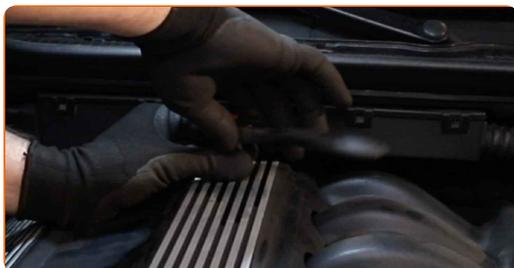
**4** Rimuovere la copertura del motore.
