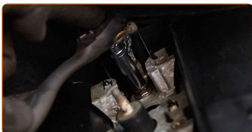
**19** Svitare gli elementi di fissaggio del coperchio della valvola del motore. Utilizza una chiave a bussola N°10. Usa una chiave a cricchetto.
