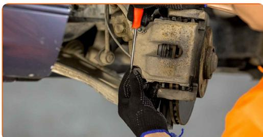
9 Pulisci l'area nella quale il tubo del freno è connesso alla pinza, e la zona dei perni guida. Usa una spazzola metallica. Usa un pulitore freni.
