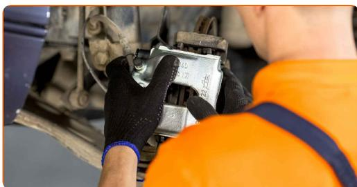
**21** Montare i tappi dei parapolvere delle guide pinza freno.
