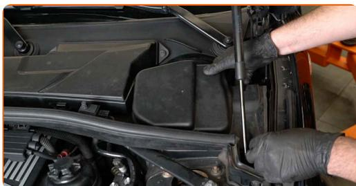
**34** Rimuovi la copertura di protezione del parafrango.
