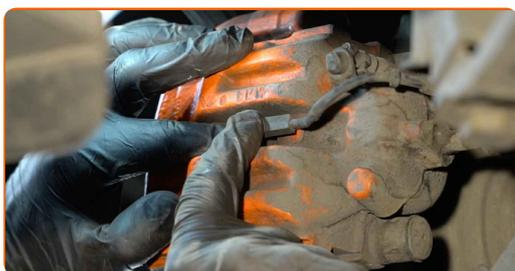
**25** Installare la molla di fissaggio della pinza freno.
