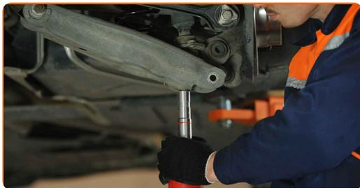
**19** Stringi l'elemento di fissaggio inferiore dell'ammortizzatore. Utilizza una chiave a bussola N°E12. Usa una chiave dinamometrica. Serralo fino allo coppia di torsione di 47 Nm.
