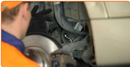
**12** Rimuovi l'elemento di fissaggio posteriore del braccio di sospensione.
