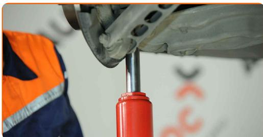
**22** Stringere l'elemento di fissaggio del braccio al fusello di ruota. Utilizza una chiave a bussola N°18. Usa un giramaschi. Usa una chiave dinamometrica. Serralo fino allo coppia di torsione di 100 Nm.
