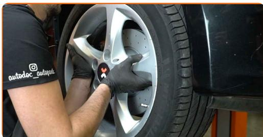
Sostituzione: sensore usura pastiglie freni - BMW 1 Hatchback (E81).
