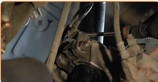
**9** Pulisci gli elementi di fissaggio del sensore ABS. Usa una spazzola metallica. Usa lo spray WD-40.
