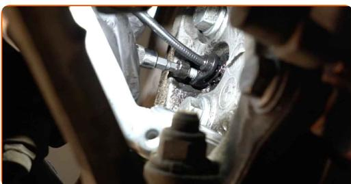
**11** Rimuovere il sensore ABS dal fuso a snodo. Usa delle pinze a becchi lunghi.
