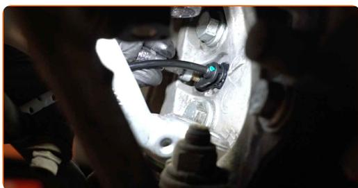
**16** Collegare il cablaggio del sensore ABS.
