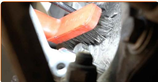
**10** Svitare l'elemento che fissa il sensore ABS al fuso a snodo. Usa una chiave HEX N.H5. Usa una chiave a cricchetto.
