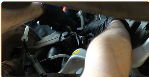
**17** Collega il connettore del sensore di velocità ABS.
