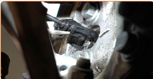
**12** Pulire la sede di montaggio del sensore ABS. Usa una spazzola metallica. Usa un detergente spray multiuso.
