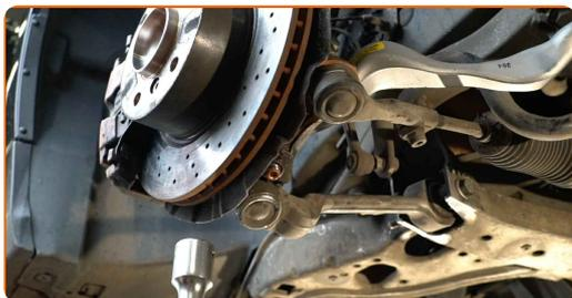
Sostituzione: braccio inferiore anteriore - BMW E82. AUTODOC raccomanda:
