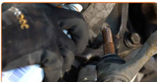
18 Installa gli elementi di fissaggio del braccio di controllo.
