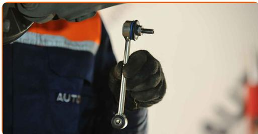
**13** Installare l'elemento che fissa l'asta allo stabilizzatore e serrarlo. Utilizza una chiave a bussola N°13. Usa una chiave dinamometrica. Serralo fino allo coppia di torsione di 21 Nm.
