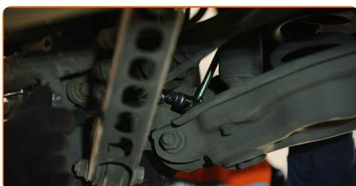
**14** Serra gli elementi di fissaggio che collegano il tirante della barra stabilizzatrice alla barra. Utilizza una chiave combinata N°17 (2 pezzi). Usa una chiave dinamometrica. Serralo fino allo coppia di torsione di 58 Nm.
