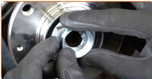
**24** Serrare l'elemento di fissaggio del mozzo. Utilizza una chiave a bussola N°41. Usa una chiave dinamometrica. Serralo fino allo coppia di torsione di 275 Nm.
