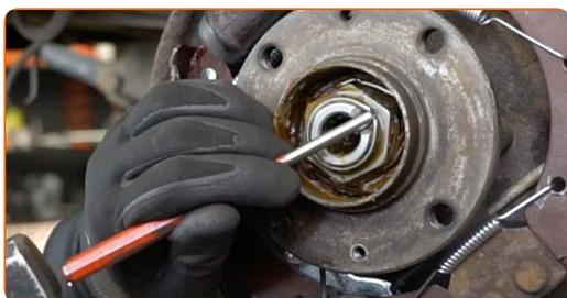
**14** Svitare gli elementi di fissaggio del cuscinetto del mozzo. Utilizza una chiave a bussola N°41. Usa un giramaschi.
