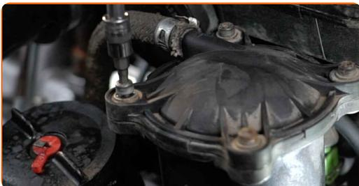
**5** Rimuovere il coperchio dell'alloggiamento del filtro carburante.
