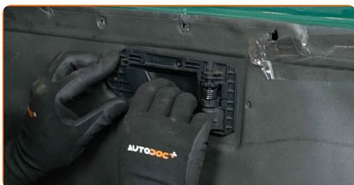
**28** Rimontare il pannello interno della portiera. Assicurati di sentire un clic indicante che si trova installato saldamente.
