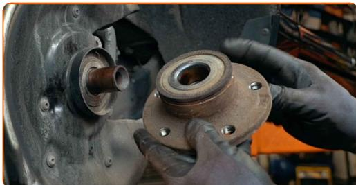
**23** Pulisci la sede di montaggio del cuscinetto del mozzo. Usa una spazzola metallica. Usa un detergente spray multiuso.
