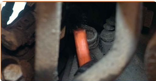
14 Svitare l'attacco della staffa pinza freno. Usa la chiave XZN n.14. Usa un giramaschi.
