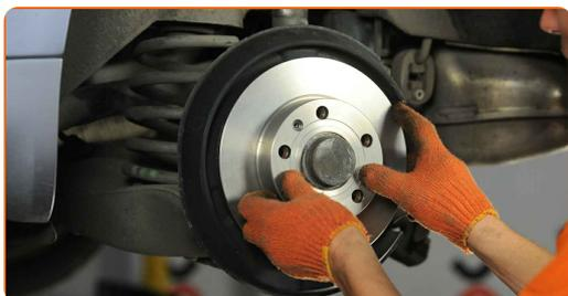
**22** Serrare l'attacco del disco freno. Usa la chiave Torx T 30. Usa una chiave dinamometrica. Serralo fino allo coppia di torsione di 5 Nm.
