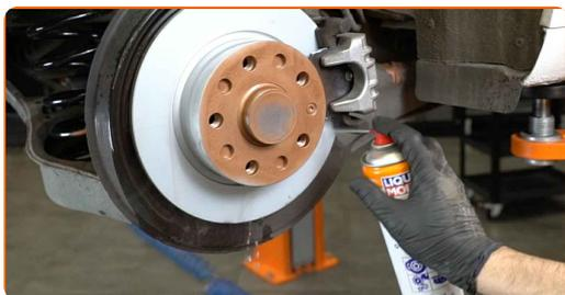
Sostituzione: dischi freni - Audi A4 B7 Avant. Gli esperti di AUTODOC raccomandano:
