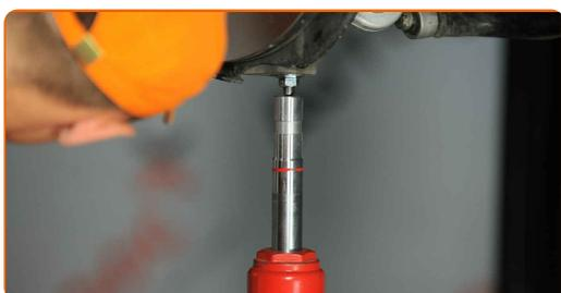
Sostituzione: supporto ammortizzatore - Audi A4 B7 Avant. Gli esperti di AUTODOC raccomandano:
