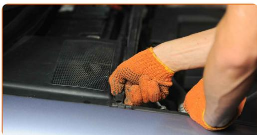
**17** Rimuovi la griglia sottoparabrezza posizionata nel lato destro.
