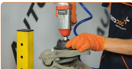
Sostituzione: supporto ammortizzatore - Audi A4 B7 Avant. I professionisti raccomandano:
