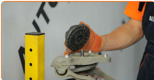
Sostituzione: supporto ammortizzatore - Audi A4 B7 Avant. Il consiglio di AUTODOC:
