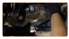
Serra l'elemento di fissaggio che collega la barra stabilizzatrice con il braccio di sospensione. Utilizza una chiave combinata N°13. Utilizza una chiave combinata N°16. Usa una chiave dinamometrica. Serralo fino allo coppia di torsione di 40 Nm. +90°
