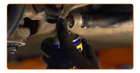
Svita l'elemento di fissaggio che collega la barra stabilizzatrice al braccio di sospensione. Utilizza una chiave combinata N°13. Utilizza una chiave combinata N°16.
