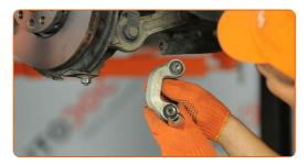
Sostituzione: biellette barra stabilizzatrice - Audi A4 B7 Avant. Il consiglio di AUTODOC:
