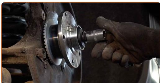
**23** Serra l'elemento di fissaggio del cuscinetto del mozzo ruota. Usa una chiave HEX N.H19. Usa una chiave dinamometrica. Serralo fino alla coppia di torsione di 200 Nm. +180°
