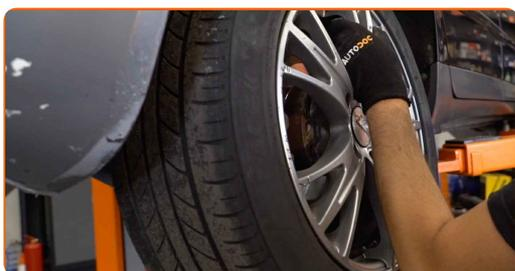
**6** Pulisci gli elementi di fissaggio della pinza freno. Usa una spazzola metallica. Usa lo spray WD-40.
