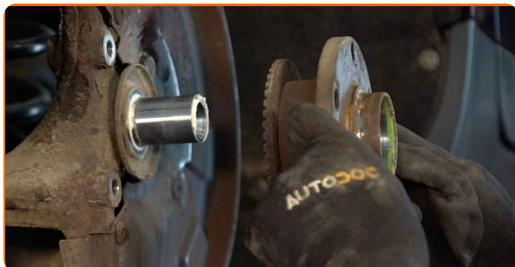
**20** Pulisci la sede di montaggio del cuscinetto del mozzo. Usa un detergente spray multiuso.
