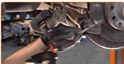
**10** Pulisci gli elementi di fissaggio del supporto pinza freno. Usa una spazzola metallica. Usa lo spray WD-40.
