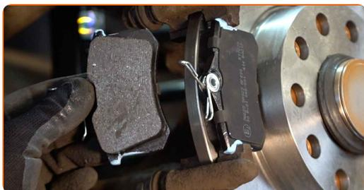
**34** Montare la pinza del freno e fissarla. Utilizza una chiave a bussola N°13. Utilizza una chiave combinata N°15. Usa una chiave dinamometrica. Serralo fino allo coppia di torsione di 35 Nm.
