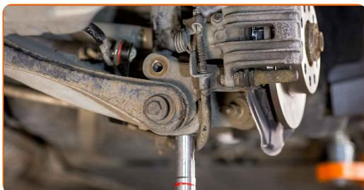
**9** Smonta la parte inferiore dell'ammortizzatore. Usa un cacciaspina. Usa un martello.
