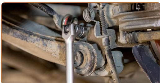
**8** Puntellare il braccio. Usa un cric idraulico per trasmissione.
