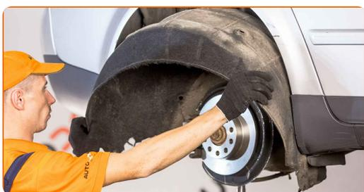
**12** Svita l'elemento di fissaggio superiore dell'ammortizzatore. Usa una chiave HEX N.H6. Usa una chiave a cricchetto.
