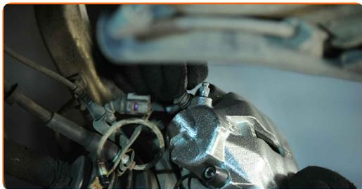
**24** Installare la molla di fissaggio della pinza freno. Usa delle pinze.
