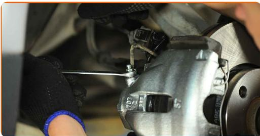
**29** Spurgare la pinza del freno. Senza avviare il motore, premere il pedale del freno più volte finché non viene percepita una resistenza significativa.
