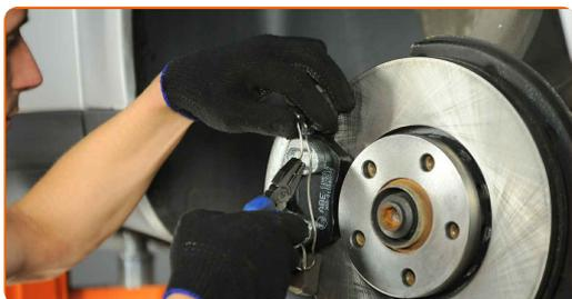
**25** Installare e fissare il tubo flessibile del freno nella nuova pinza. Utilizzare una chiave poligonale aperta#10.
