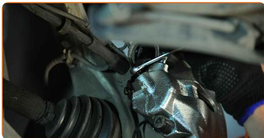
**26** Fissare la staffa di fissaggio del tubo flessibile freno. Utilizzare una chiave poligonale aperta#10.
