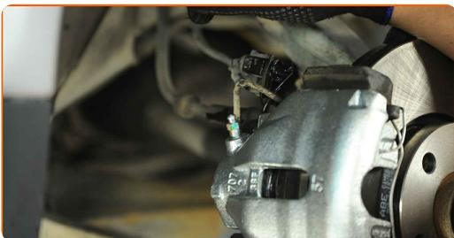
**31** Disconnetti il tubo flessibile del kit di spurgo freno pneumatico.
