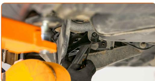
**16** Avvita le staffe di supporto della boccia dello stabilizzatore. Usa la chiave XZN n.10. Usa una chiave dinamometrica. Serralo fino allo coppia di torsione di 45 Nm.
