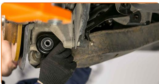
**15** Avvita il nuovo elemento di fissaggio del braccio di controllo al telaio ausiliario posteriore. Utilizza una chiave combinata N°18. Utilizza una chiave a bussola N°18. Usa una chiave a cricchetto.
