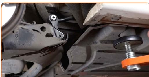
**12** Serra l'elemento di fissaggio che collega la barra stabilizzatrice con il braccio di sospensione. Utilizza una chiave combinata N°16. Utilizza una chiave a bussola N°16. Usa una chiave dinamometrica. Serralo fino allo coppia di torsione di 40 Nm.
