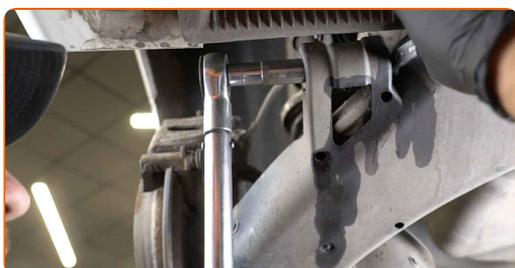
**13** Serra gli elementi di fissaggio che collegano il tirante della barra stabilizzatrice alla barra. Utilizza una chiave a bussola N°8. Usa una chiave dinamometrica. Serralo fino allo coppia di torsione di 40 Nm.
