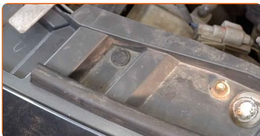
20 Avvita gli elementi di fissaggio superiori del paraurti. Utilizza una chiave a bussola N°10. Usa una chiave a cricchetto.
