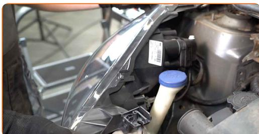
17 Avvita gli elementi di fissaggio del fanale. Utilizza una chiave a bussola N°10. Usa una chiave a cricchetto.
