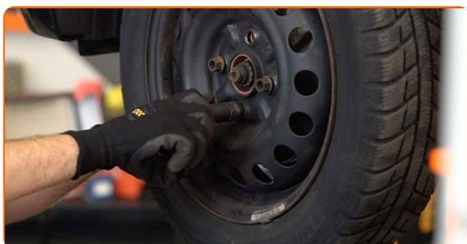
31 Rimettere il veicolo per terra e, lavorando in ordine incrociato, serrare i bulloni di fissaggio delle ruote. Usa una chiave dinamometrica. Serralo fino allo coppia di torsione di 103 Nm.
