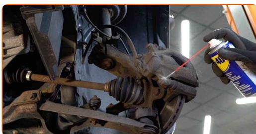
9 Svitare l'attacco della pinza freno. Utilizza una chiave a bussola N°13. Usa una chiave a cricchetto.
