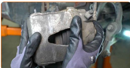
Sostituzione: dischi freni - AUDI TT Roadster (8N9). AUTODOC raccomanda:
