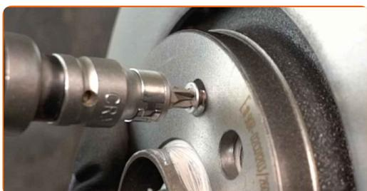
**21** Stringere gli elementi di fissaggio del disco del freno. Usa un cacciavite Phillips. Usa una chiave dinamometrica. Serralo fino alla coppia di torsione di 4 Nm.
