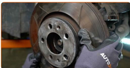
**16** Pulire il supporto della pinza del freno da sporco e polvere. Usa una spazzola metallica. Usa un pulitore freni.
